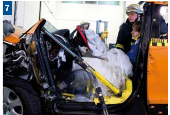
Erweitern des Fußraums durch Rettungszylinder
